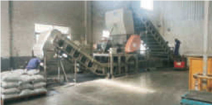
工艺流程（图右方为投料点，图左方为出料装袋）
